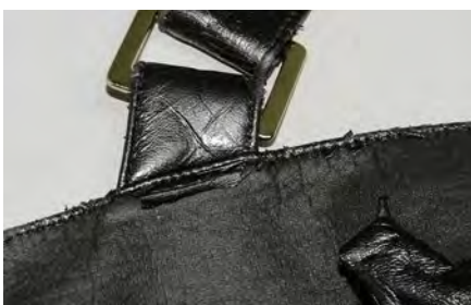
L'enduction est dégradée à plusieurs endroits.
